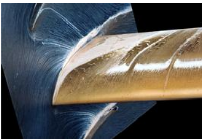
Schlierenbild des Stoßsystems eines transsonischen Profilschnitts ( Ma = 1,25 )
