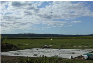
Mikrofonarray für die Messungen im EU Projekt AWIATOR, im Hintergrund die A340 auf dem Rückflug zur Messstelle
