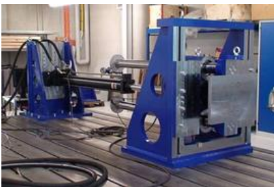
Prüfstand für Zug/Druck +/- 100 kN
