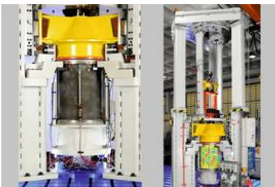
Kreiszyinderschale in Dynamikbeulanlage, Detail- und Gesamtansicht
