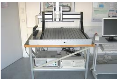
USPC 3010 HF mit 3-Achs-Scanner
