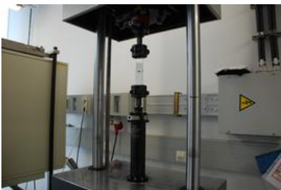
Dauerschwingversuch an einer fließformverschraubten Magnesium-Aluminium-Zugscherprobe
